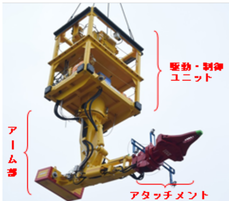
▲装置全景 (クレーンで吊り下げて使用) 重 量： 約 18t 駆動装置： 油圧
