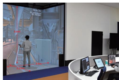
1F建屋のデータを整備。 各種3Dデータが投影可能なVRシステム
